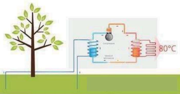
Aus dem Grundwasser (oder aus dem Boden) wird über einen offenen (oder geschlossenen) Sondenkreislauf die Wärme entnommen, um sie in einem Verdampfer an das zu erwärmende natürliche Kältemittel abzugeben. TEON HTHPs erhöhen die Temperatur dank der patentierten WaterBlaze®-Technologie in einem hocheffizienten Verdichter von wenigen Grad Celsius auf bis zu 95°C und bei Bedarf mehr. Das Wasser wird der Natur ohne chemische Veränderung wieder so zugeführt, wie es ihm entnommen wurde.
